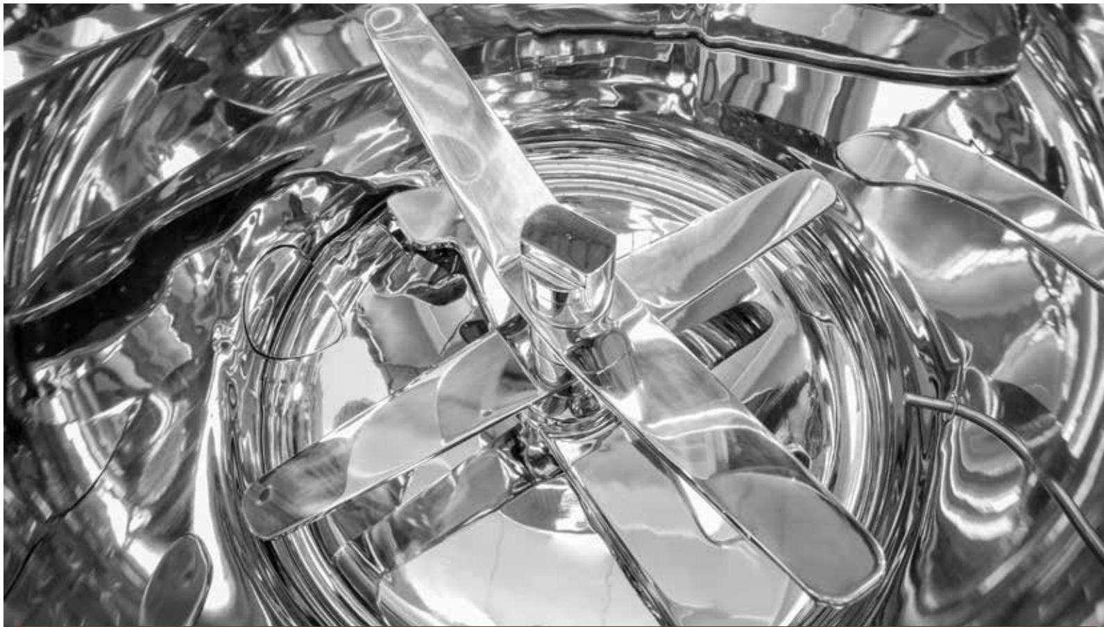
Camera di miscelazione in acciaio inox, caratterizzata da superfici lisce per rendere più rapide e accurate le operazioni di pulizia.
