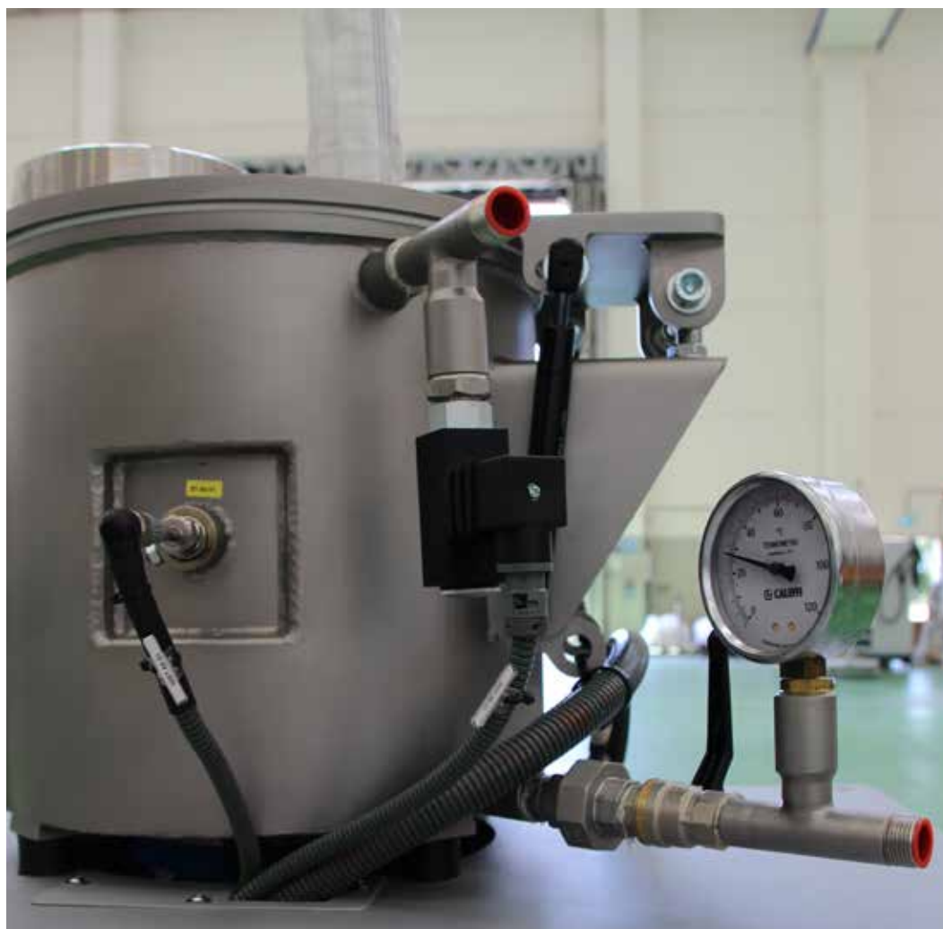
Particolare della sonda e del circuito di raffreddamento di un miscelatore Mixron MLT.
